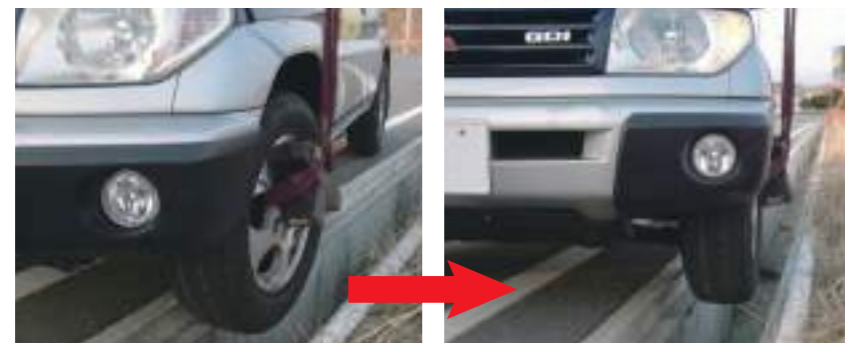
フェンダーとスリングベルトの間にスペースを確保し、吊上げ時のキズを防止します。
